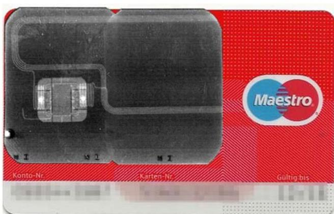
Abb. 1) Röntgenbild einer EC-Karte mit HF-RFID TAG
