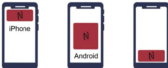
Abb. 4) typische NFC-Antennenpositionen bei Smartphones
