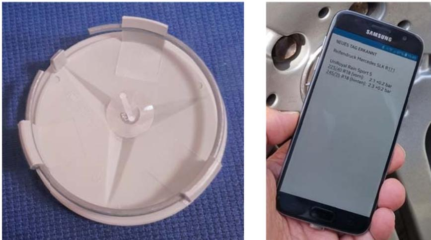
Abb. 23) Radnabenabdeckung mit NFC-TAG, Abfrage der Reifendaten am Rad
