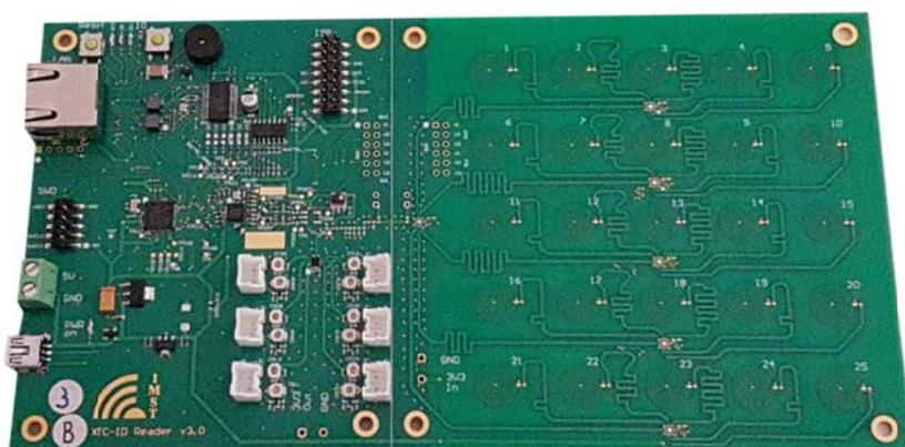
Abb. 67) XTC-ID Reader Variante B mit 6 externen Antenneneingängen
