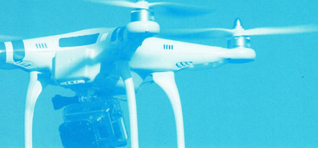
**Doel van het deelproject is het middels een deels autonoom vliegende drone omgevingsdata te verzamelen in tuinbouwkassen. Na het bepalen van de relevante omgevingsdata kon een drone met voldoende draagkracht worden gespecificeerd. De uitdaging bestond uit het (deels autonoom) op centimeters nauwkeurig te vliegen in een gesloten ruimte (indoor), zoals tuinbouwkassen.**
